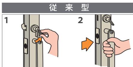
ツマミを回してラッチ解除を行う従来型に対して、GA1型はハンドルのレバーを握るだけでラッチが解除、そのままのハンドル操作で開閉ができます。
